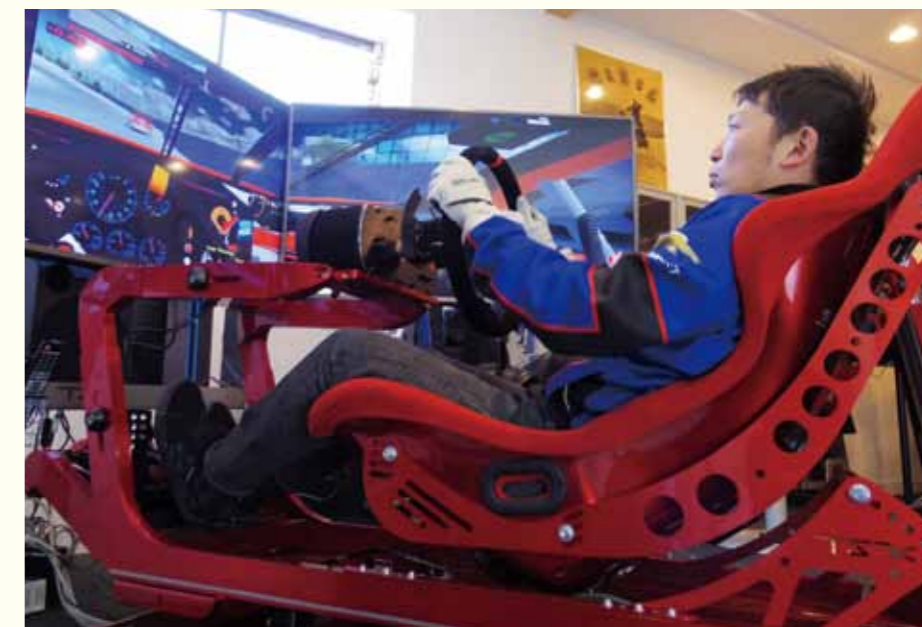
古賀選手が乗るのはモーションを取り入れた最新モデル「T3R」。シート全体の動きもリアルに再現され、全身で行うプロのドライビングを可能にしました。
